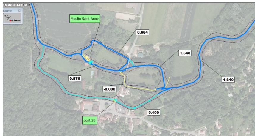
Figure 52: Répartition des débits à Sainte-Anne en étiage – avec arasement du déversoir
